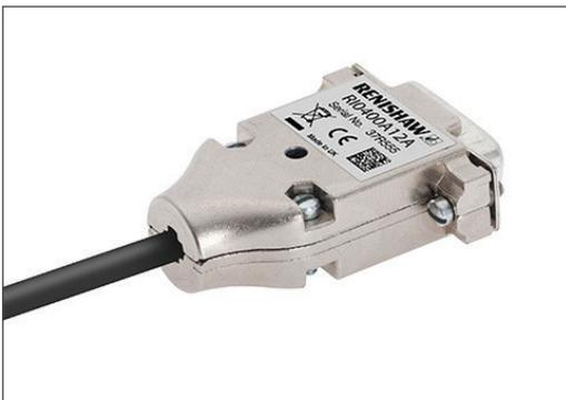
**Ri** Interface sind in einem Steckergehäuse eines 15-pol. SUB-D Steckers mit CAL-Taste integriert. Sie bieten digitale Interpolation bis 50 nm (getaktet) bzw. 0,5 µm (nicht getaktet). Analoge Varianten sind ebenfalls erhältlich.
