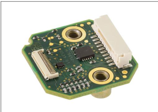
**ACi** Interface sind leistungsfähige Interpolatoren in kleiner Bauform. Damit lassen sich einmalige Preis-Leistungs-Vorteile bei hochentwickelten Verfahrsachsen erzielen, die feine Auflösungen in Verbindung mit hohen Geschwindigkeiten in einer ultrakompakten Lösung und geringem Platzbedarf erfordern. Digitale Interpolation bis auf 10 nm ist bei einem getakteten Ausgang mit bis zu 40 MHz erhältlich. Versionen mit FPC- oder Kabeleingang erhältlich.
