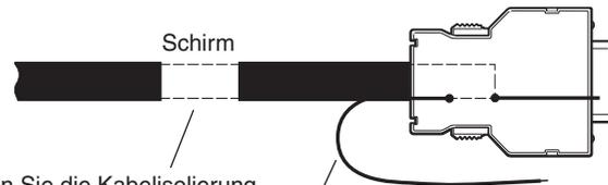
**Option 2:** Entfernen Sie die Kabelisolierung, um die Geflechschirmung offenzulegen und an die Maschinenerde anzuschließen.
