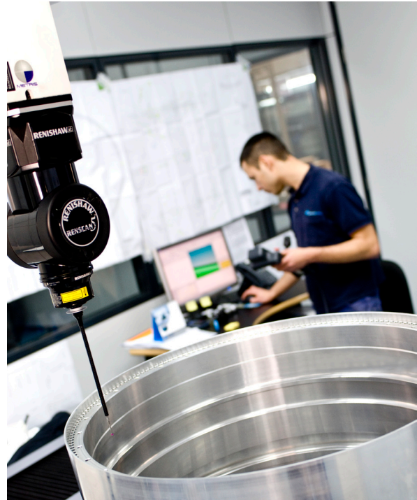
REVO® escaneando una gran circunferencia en un componente aeroespacial.
