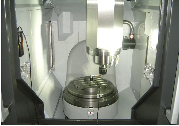
在 NMV 立式車削中心上執行循圓測試儀測試
