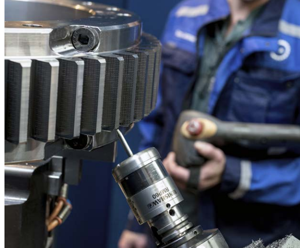
Renishaw RMP60 測頭在去毛邊後確認完成的齒輪尺寸
